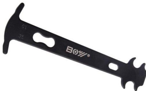
*Можно говорить об износе, когда цепь увеличена. Очень сложно оценить величину износа на глаз. На этом инструменте указано только два значения: 0,75 мм и 1 мм. Цепь можно заменить, если она растянулась всего на 0,75 мм. Если измеритель показал растяжение на 1 мм, то цепь можно выбрасывать.*
